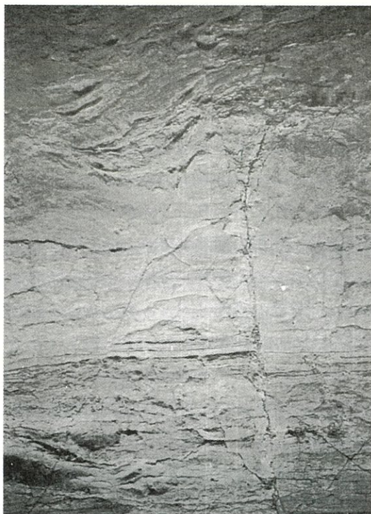
写真-4 東海層群の中の小断層（名古屋市緑区） シルト岩中の斜交する割れ目、変位は数cm～10cm 程度。
