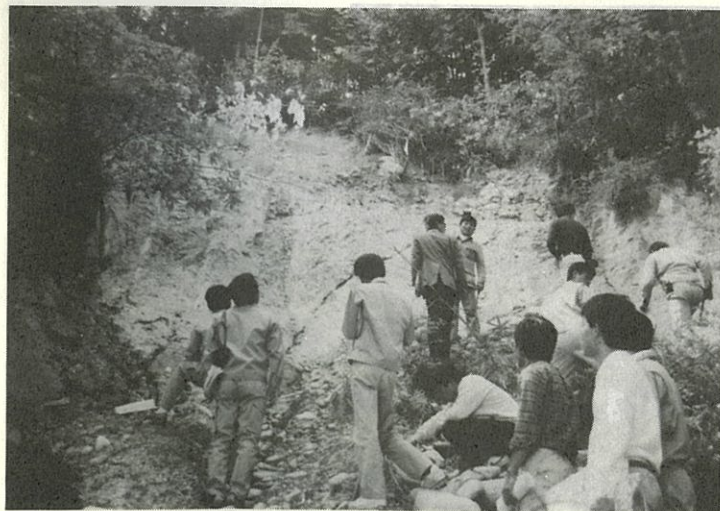
ph-15 阿寺断層における破碎帯 （花崗岩系）
